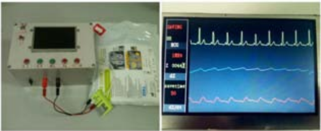
图 7 样机及液晶屏显示效果
