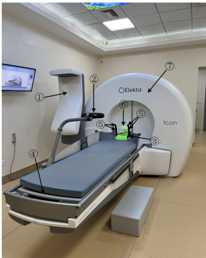
图1 Leksell Icon 型伽玛刀 Figure 1 Leksell Icon Gamma Knife ①CBCT;②红外摄像头;③面罩适配器;④治疗床;⑤参考 标记点;⑥鼻尖标记;⑦射线治疗单元
