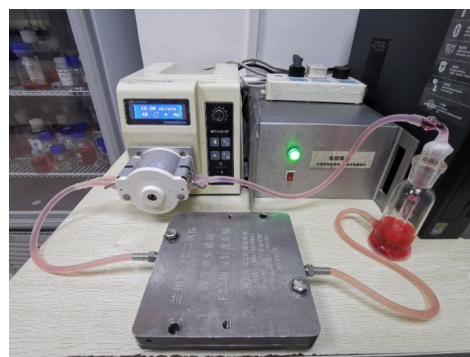
图1 本实验室自主研发设计的流体剪切力加载装置
