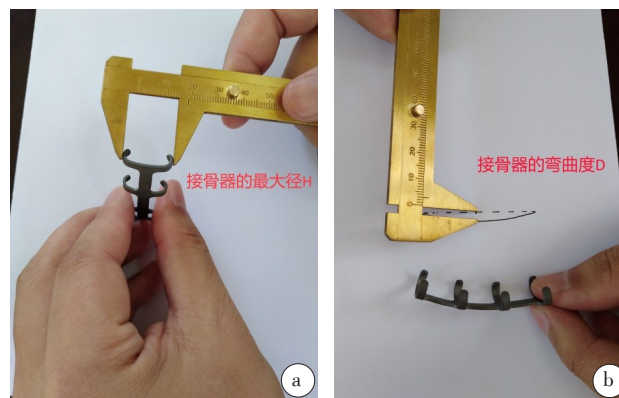
图3 肋骨接骨器最大径 H 值及弯曲度 D 值
