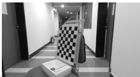
a: RGB camera calibration
