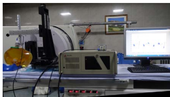
图4 人体切片模体的光声信号采集系统实物
