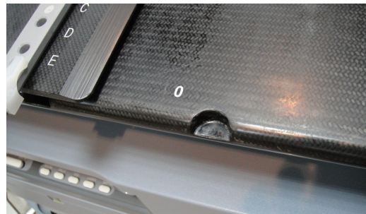
图2 碳纤治疗床床面固定凹槽设计
