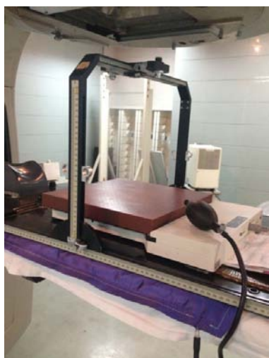
图1 床面倾斜模拟系统
