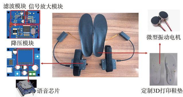
图3 足底微振动刺激鞋垫整体设计
