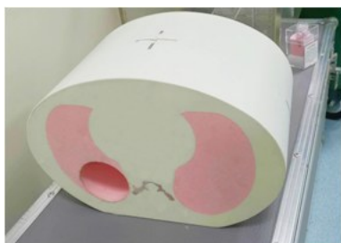
图1 CIRS 公司 008A 胸部仿真模体 Figure 1 Chest phantom 008A of CIRS
