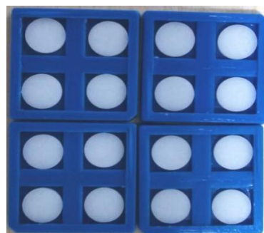
图1 装有4片TLD的片匣示意图
