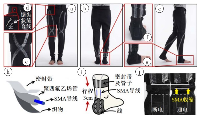
图 11 SMA 线驱动智能服装 Figure 11 SMA wire actuated smart clothing a: 正视图; b: 后视图; c: 侧视图; d: 腰部 SMA 固定局部视图; e: 膝关节处导线布置局部视图; f: 脚跟背面导线布置局部视图; g: 脚踝侧面导线布置局部视图; h: SMA 执行器结构示意图; i: 智能服装脚部结构示意图; j: 脚部执行器通断电对比图
