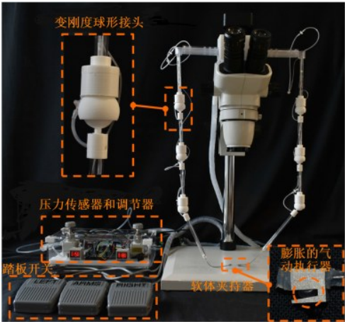
图5 双臂式软体机器人夹持系统 Figure 5 Dual arm soft robot clamping system
