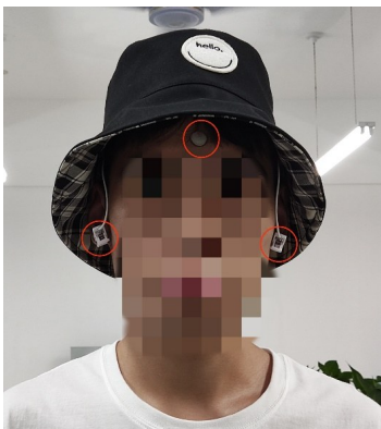
图 10 受试者佩戴 EEG 波传感器 Figure 10 Subject wearing EEG sensors
