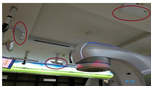
图1 OSMS摄像单元安装位置
