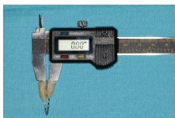
图5 改装后的游标卡尺 Fig.5 Modified vernier caliper
