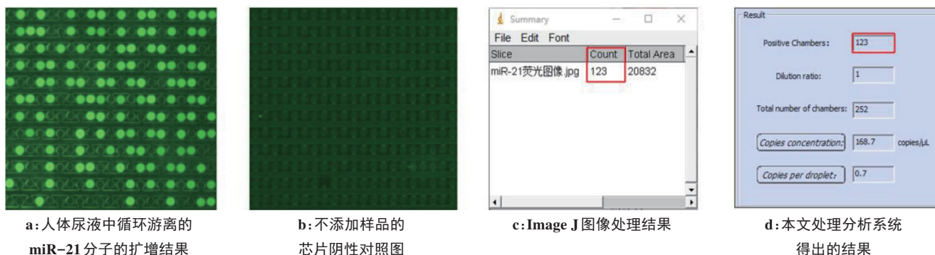
图8 使用数字等温扩增微流控芯片扩增人体尿液中循环游离的 miR-21 分子的结果
