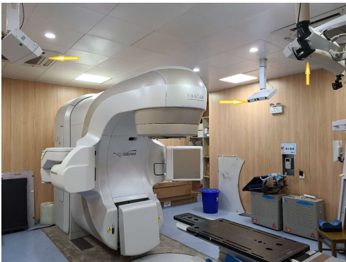
图1 VitalBeam 加速器及天花板上的 OSMS 的摄像头 (图中箭头所示)
