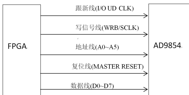
图9 FPGA与AD9854连线图
