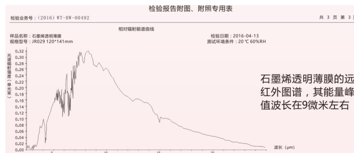
图1 石墨烯发热膜的红外线谱图
