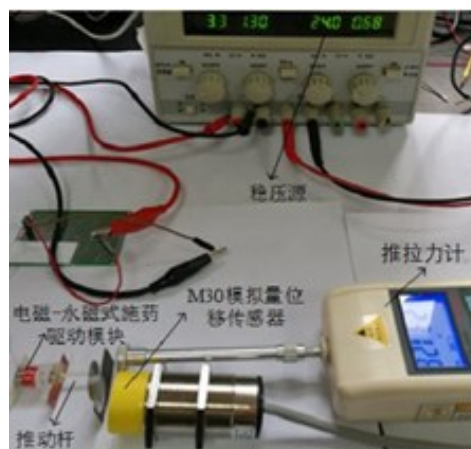
图4 磁场驱动力测试平台
