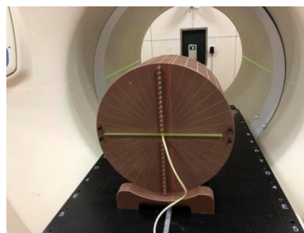
图2 旋转输出剂量检测摆位图
