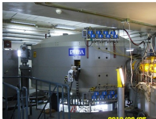
图1 IBA 230 MeV 医用质子加速器 Fig.1 IBA 230 MeV medical proton accelerator
