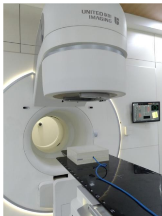
图2 固体水模体置于治疗床位置示意图,电离室置于固体水等中心位置
