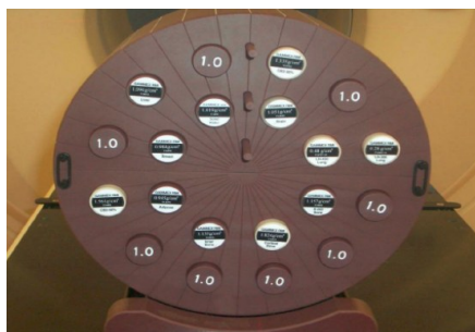
图1 不同密度插件的Tomophantom模体
