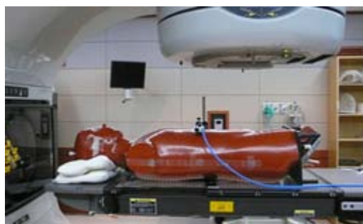
图1 RANDO验证模体剂量测量示意图
