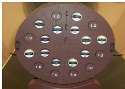
图1 不同密度插件的Tomo phantom模体
