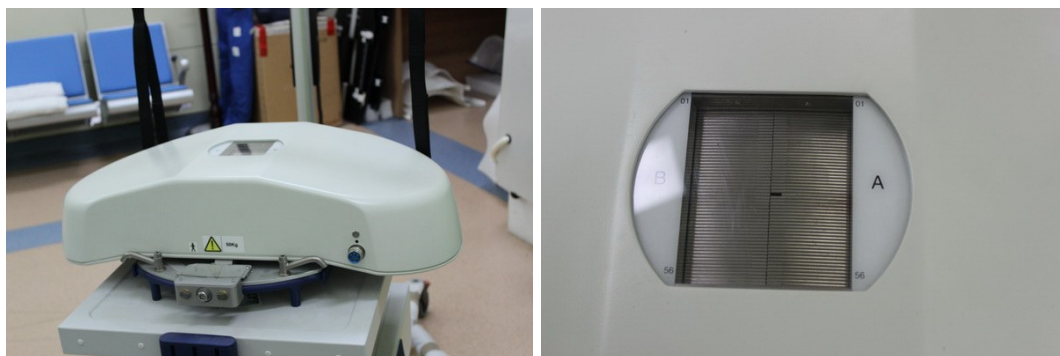
图 1 APEX 外置微型多叶准直器外观示意图
